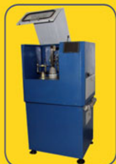
سیاب سیاره‌ای پرتوزی، مدل PBM300 (محصول شرکت نانو شات)
