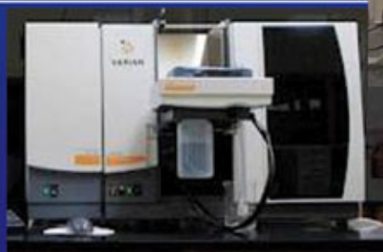
جذب اتمی با کوره گرافیتی Atomic absorption with graphite tube atomizer
