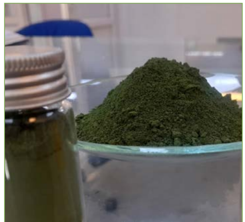
شکل ۱- نانوذرات اکسید کروم سبز سنتز شده در شرکت دُرینکا سبز پژوه از پساب آبکاری کروم
